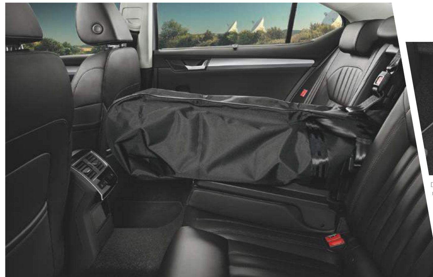
Sklopná zadní loketní opěra umožňuje vytvořit otvor mezi kabinou a zavazadlovým prostorem. Tudy pak jednoduše prostrčíte vyjímatelý vak Unibag určený pro bezpečné převážení lyží nebo snowboardu.
