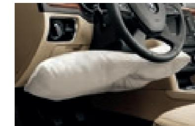
Der **Knieairbag** unter der Lenksäule schützt Knie und Schienbeine des Fahrers.
