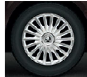
Stahlfelgen und Radzierblenden **Solaris** 7,0J x 16" mit 205/55-R16-Bereifung, Serie bei Active.
