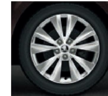
Leichtmetallfelgen **Twister** 7,0J x 17" mit 225/45-R17-Bereifung, Serie bei Elegance sowie Active und Ambition 2,0 | TSI/147 kW und Ambition 3,6 | V6/191 kW.
