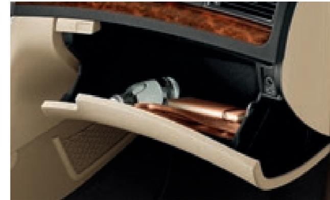
Das **klimatisierbare Handschuhfach** wird während der Fahrt von der Klimaanlage Climatronic mit kühler Luft versorgt.
