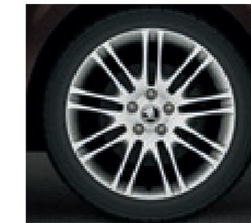
Leichtmetallfelgen **Luxon** 7,5J x 18" mit polierter Oberfläche (glanzgedreht) und 225/40-R18-Bereifung, optional für Ambition und Elegance.
