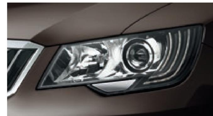
Schon von Weitem unverkennbar: Die **Bi-Xenonleuchten mit LED-Tagfahrlicht** passen perfekt zum dynamischen Gesamteindruck des Superb. Ihre Leuchtdioden sind in zwei vertikalen Reihen an der Außenseite der Leuchten angebracht und bilden so die ŠKODA typische C-Form, die bisher auf die Heckleuchten beschränkt war.
