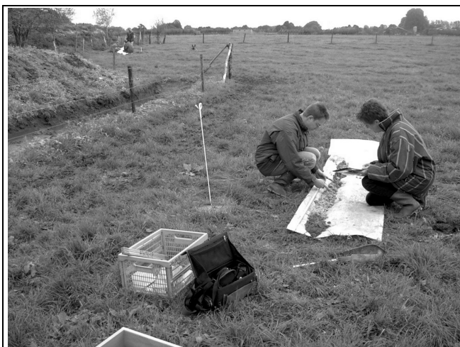
Afb. 28: De eerste boring op het hoge (noordelijkste) deel van het terrein. Duidelijk zichtbaar is de dunne laag beek-eerdgrond met daaronder het heldergele zand van de dek-zandrug. Foto D. Mittendorp
