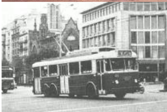
Dos ejemplos de vehículos de dos pisos o imperiales reformados a un solo piso. Arriba, el minibús ACLO-Seida, y abajo, el trolébus BUT
