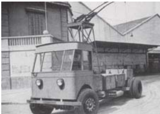
Un trolebús reconvertido en vehículo auxiliar el año 1940 para el mantenimiento y reparación de las vías de tranvías y las catenárias
