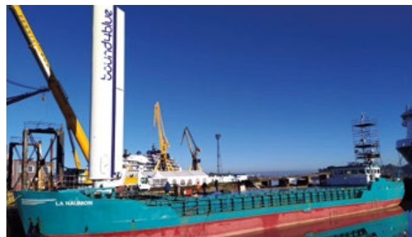
La instalación de la vela rígida tuvo lugar en el astillero Astander.
