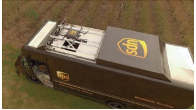
El dron octocóptero de alto rendimiento se integra en la línea de camiones eléctricos/híbridos de Workhorse.
