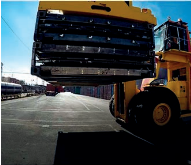
El contenedor ZBox desplegado en la prueba de carga.
