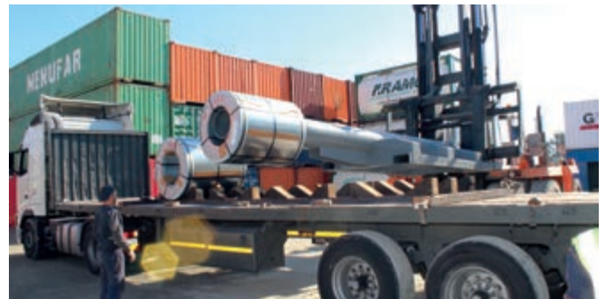
El nuevo utillaje de TMT se acopla a los reachstacker para cargar y descargar las bobinas.
