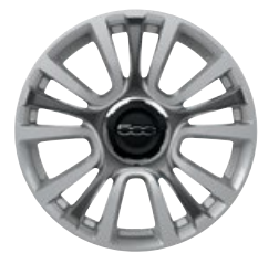
ROUES DE 17 PO EN ALUMINIUM GRIS FONCÉ ET GRIS CLAIR De série sur le modèle Trekking
