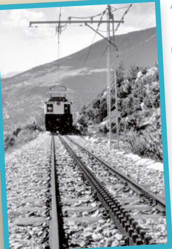
Detall d'una composició de tren ascendent a Núria gràcies a la cremallera ABT. Arxiu FGC (1960).
