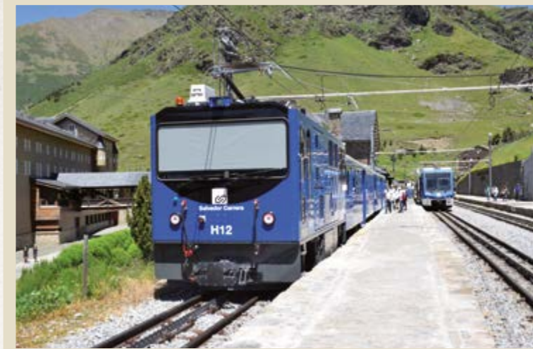
La nova locomotora híbrida H-12 a l'estació de Núria. Foto Joan C. Salmerón (2020).
