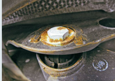
Sportlich: abgeflachtes Lenkrad im GTI (links). Die filigrane Vierlenker-Hinterachse (oben) ist einstellungssensibel und weist Flugrost auf, Scheinwerfer sind häufig undicht
