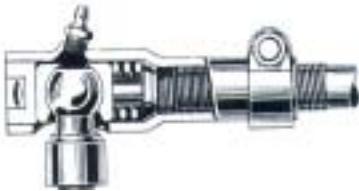
1/2 Ton Tie Rod Construction
