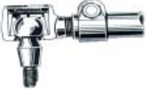
3/4 Ton Tie Rod Construction
