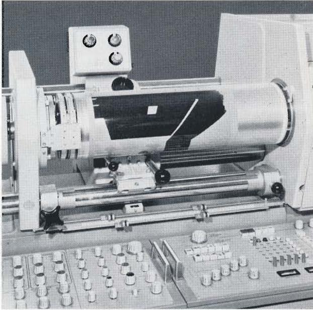
Bild 3. Eine separate Maskenwalze nimmt die Steuermaske auf. Sie steuert das Einkopieren von Schriften, Strichmotiven usw. und das Ineinanderkopieren von verschiedenen Bildmotiven, wie es vom Combi-Chromagraph CT 288 her bekannt ist. Rechts neben dem Farbrechner ist der Steuersatz angeordnet. Auf seiner Oberseite befinden sich u. a. das Programmfeld, die Dichtegeber, Regler für die Film-linearisierung und Anzeigeinstrumente für das Vakuum der Abtast- und Schreibwalze.
