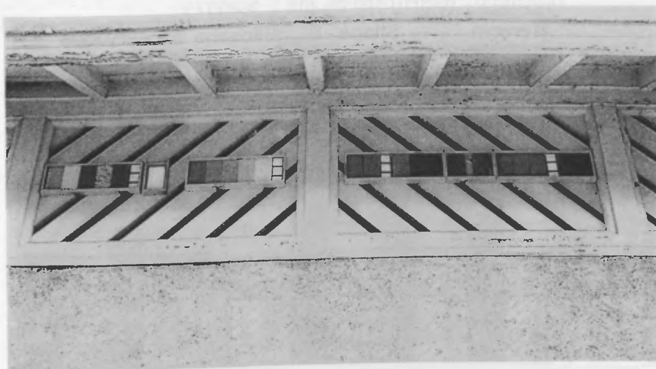
Figure 1 : Eprouvettes exposées sous un avant-toit dans un site urbain (banlieue).
