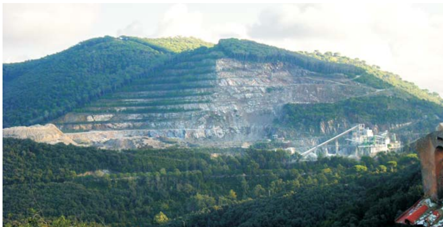
Fig. 109 - Cava attiva di colle Reciso, a nord di Lacona, nella quale viene estratta la roccia calcarea della formazione dei calcari a Caplionelle.
