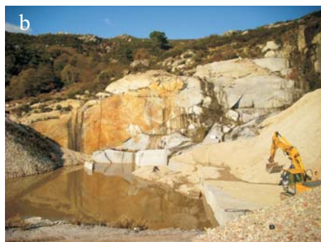
Fig. 111 - Cava di monzogranito a monte di San Piero in Campo: a) l'attività estrattiva è guidata dai sistemi di fratture primarie da raffreddamento, disposti verticalmente e parallelamente alla superficie topografica; b) un laghetto occupa temporaneamente il fondo dello scavo di coltivazione nei periodi caratterizzati da precipitazioni intense.
