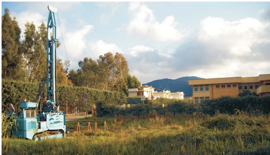
Fig. 133 - Sondaggio meccanico a carotaggio continuo S2, eseguito con sonda cingolata alle spalle dell'Istituto comprensivo di scuola materna, elementare e media di Marina di Campo.
