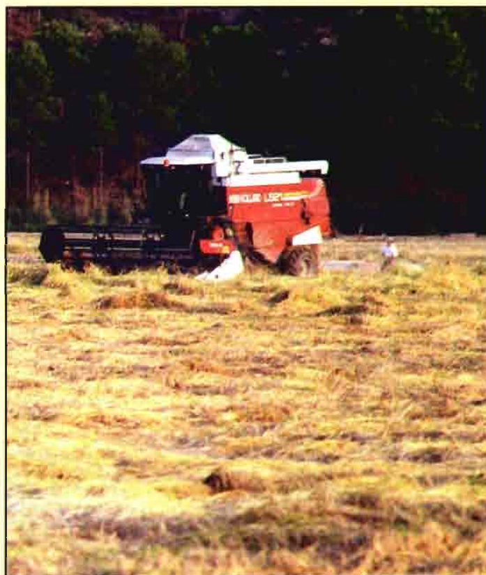
En el sistema de trilla del arroz, los cilindros convencionales deben sustituirse por cilindros de dientes. En la foto, cosechando en la zona de Calasparra.
