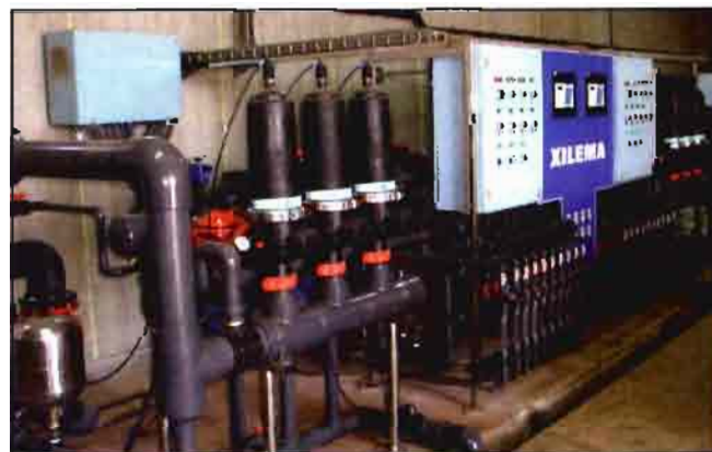
Figura 2. Equipo de fertirrigación.
