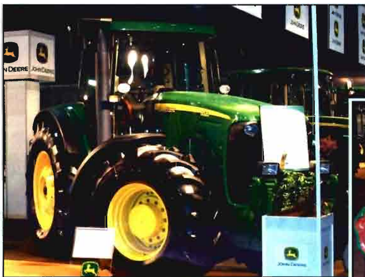
Tractor John Deere serie 8020 con suspensión independiente en el eje delantero.
