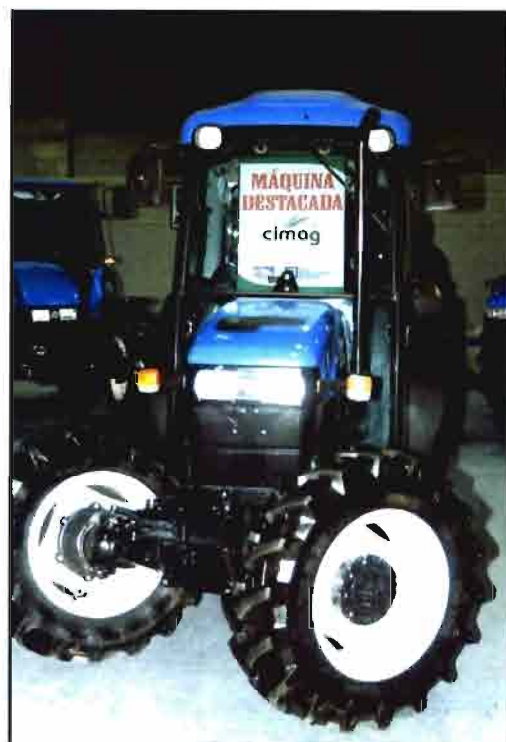
Tractor New Holland TNF-95 DT, con ángulo de giro de 76°.
