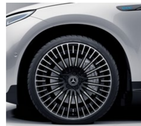
RWI – AMG 21"-Leichtmetallräder im Vielspeichen-Design – optional (CHF 2020.-) mit 235/45 R 21 auf 8,0 J x 21H2
