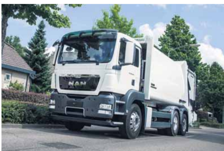
De Metropolis van MAN is een plug-in hybride vuilniswagen.
