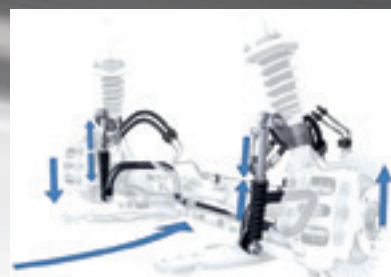
Porsche Dynamic Chassis Control (PDCC) im Porsche 911 Carrera
