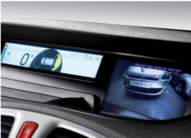
Pour faciliter et sécuriser les manœuvres de stationnement, la caméra de recul projette l'image de la zone située à l'arrière du véhicule sur l'écran de navigation.
