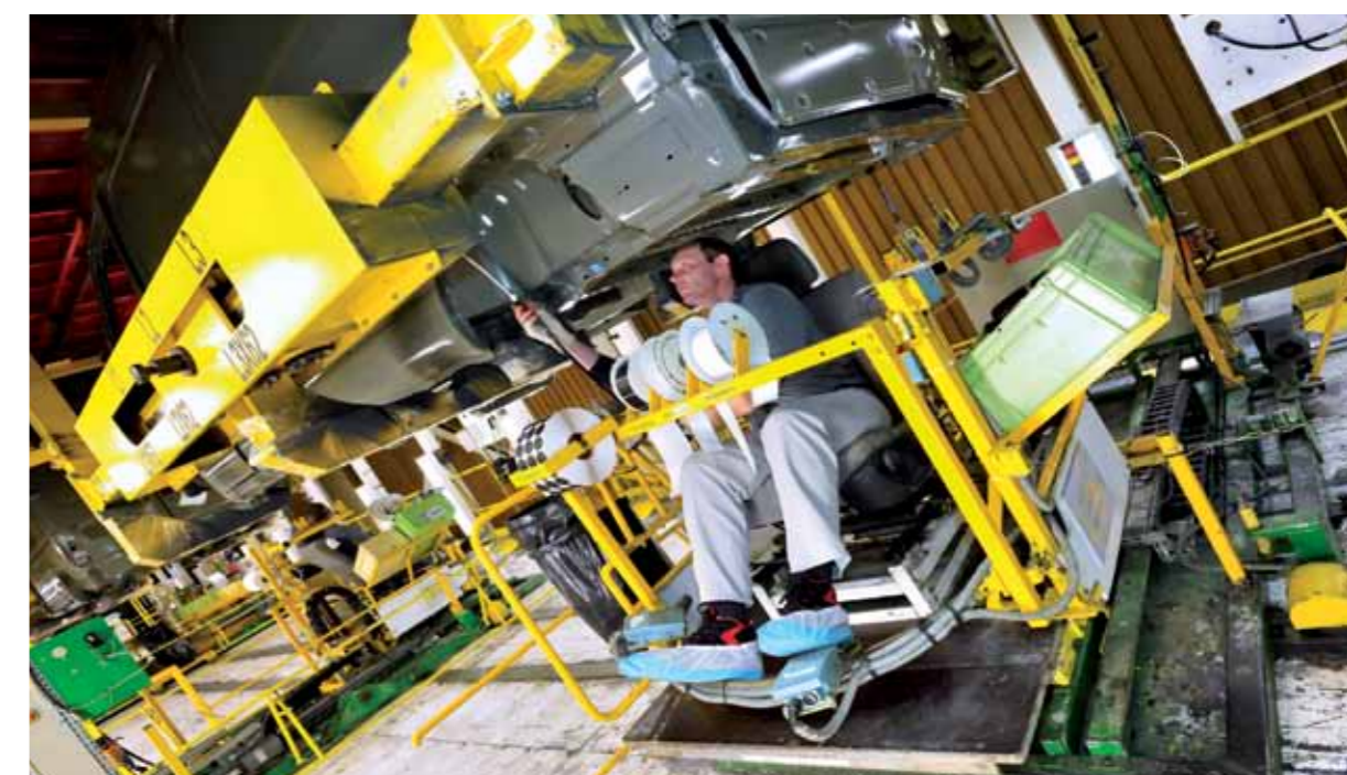
Sovab Batilly - Atelier des mastics - Servante sous caisse pour personne à mobilité réduite. Déplacements possibles par pédale ou joy stick.
