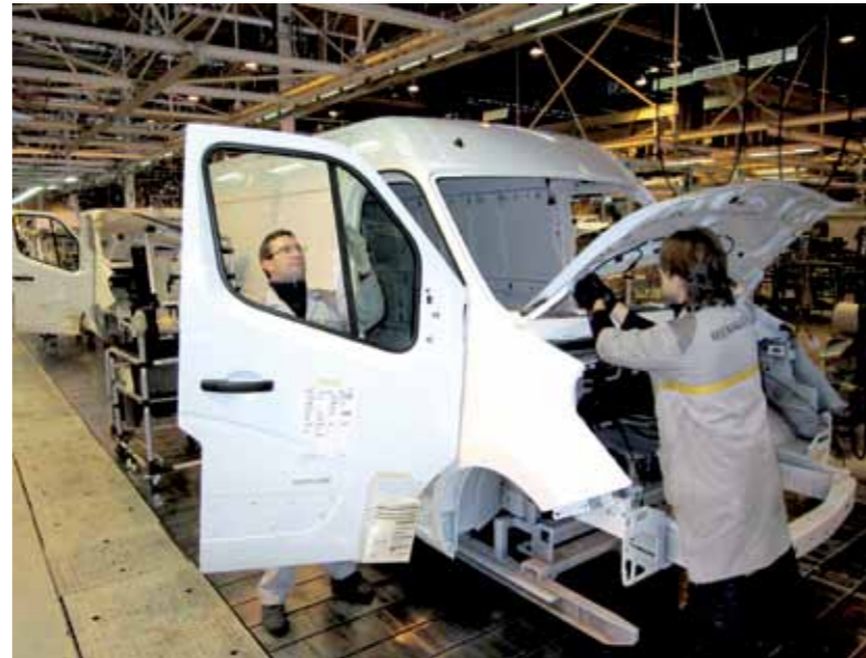
Usine de Batilly, habillage du Nouveau Master.
