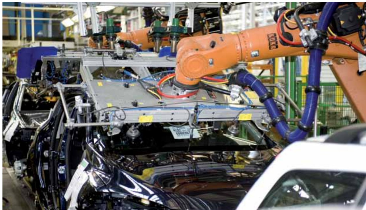
Pose de pare-brise sur Mégane 3 à l'usine de Palencia.
