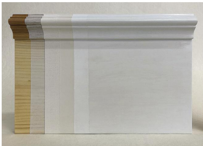
11 Farbvertiefung und Glanz durch Auftrag der Leimlöse
