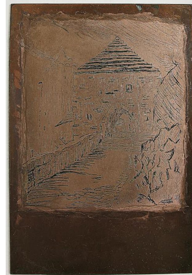
9 Eine gestochene und eine geätzte Kupferplatte mit tief liegenden Motiven zur Abformung der Hauchbildfolien
