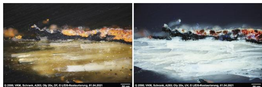
16 Querschliff einer roten Kolorierung über schwarzer Schablonierfarbe und Grundierung
