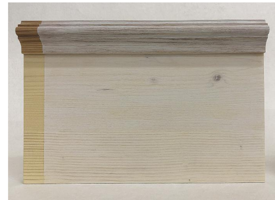
2 Weiße Leimtränke in Vorbereitung für die Grundierung
