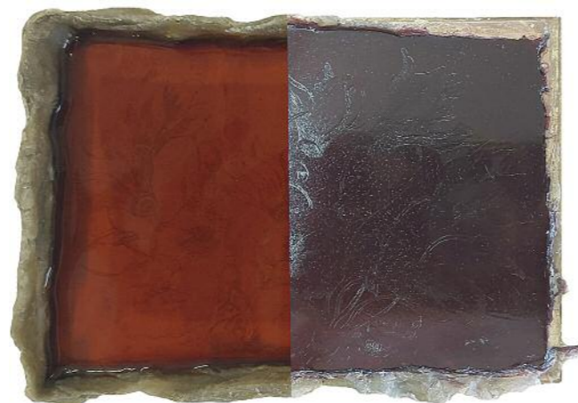
12 Mit Rotholz eingefärbte Leimlösung während des Farbumschlags (links) und mit endgültiger dunkelroter Farbe (rechts)
