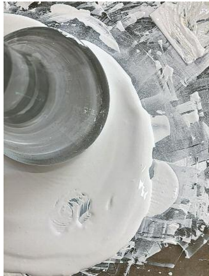
8 Herstellung der Leimfarbe für den weißen Farbanstrich aus Kreidemischung, Preußischblau und Rußschwarz
