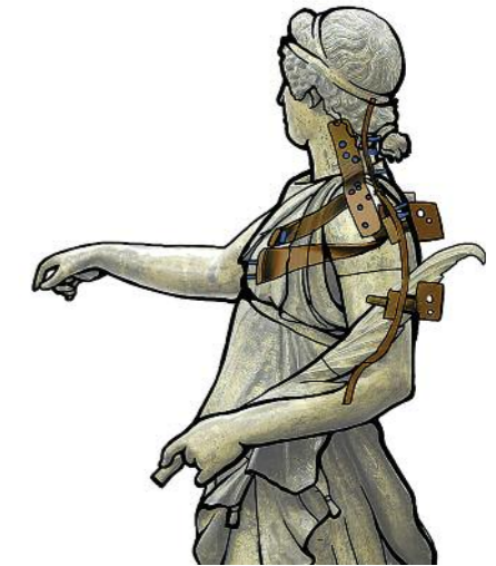
9c (oben) Tragwerk im Brustbereich zur Aufnahme der Flügel von der Neu-Restaurierung im Jahr 1844
