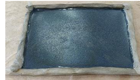
17 Die eingegossene, blau gefärbte Leimlösung während der Trocknung
