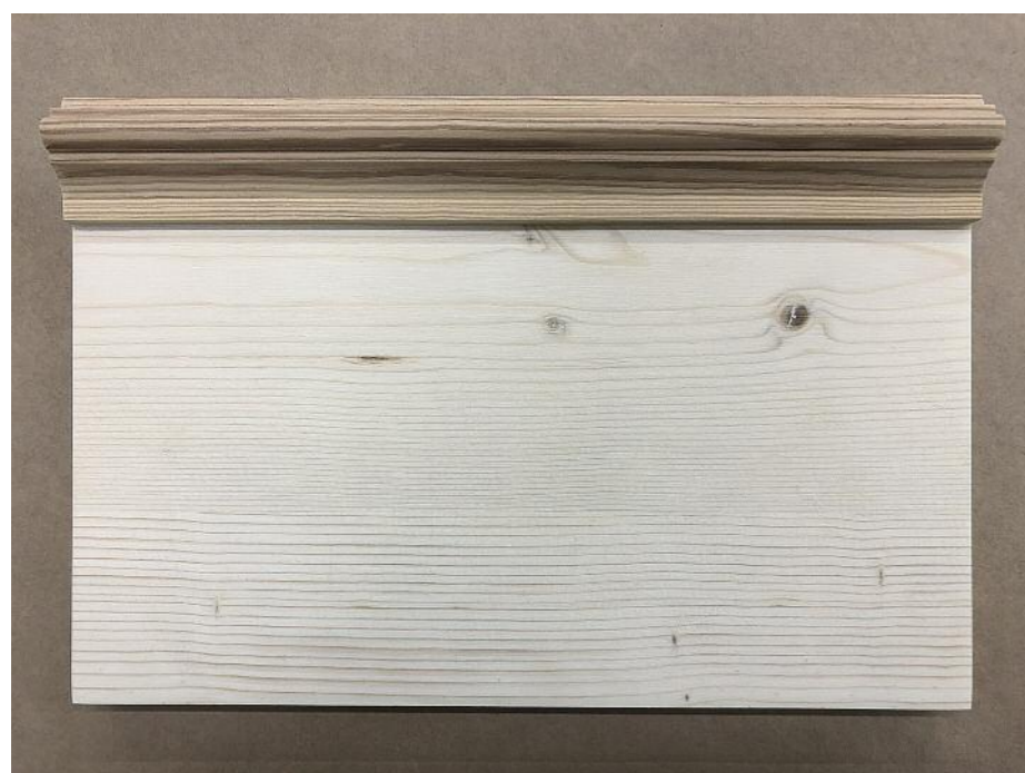
1 Hergestellte Probetafel mit aufgesetzter Profilleiste
