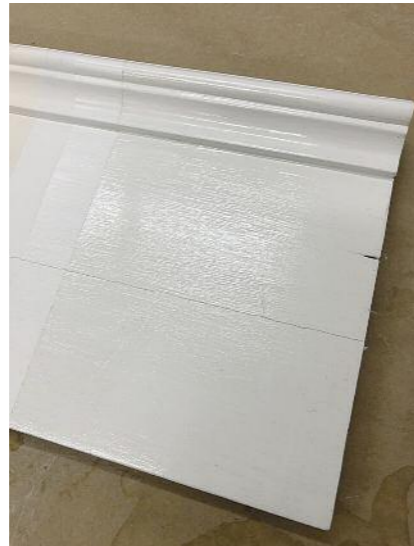
9 Pinselspuren des weißen Farbanstrichs verhindern eine ausreichende Glanzausbildung beim späteren Firnissen (Vorversuch)
