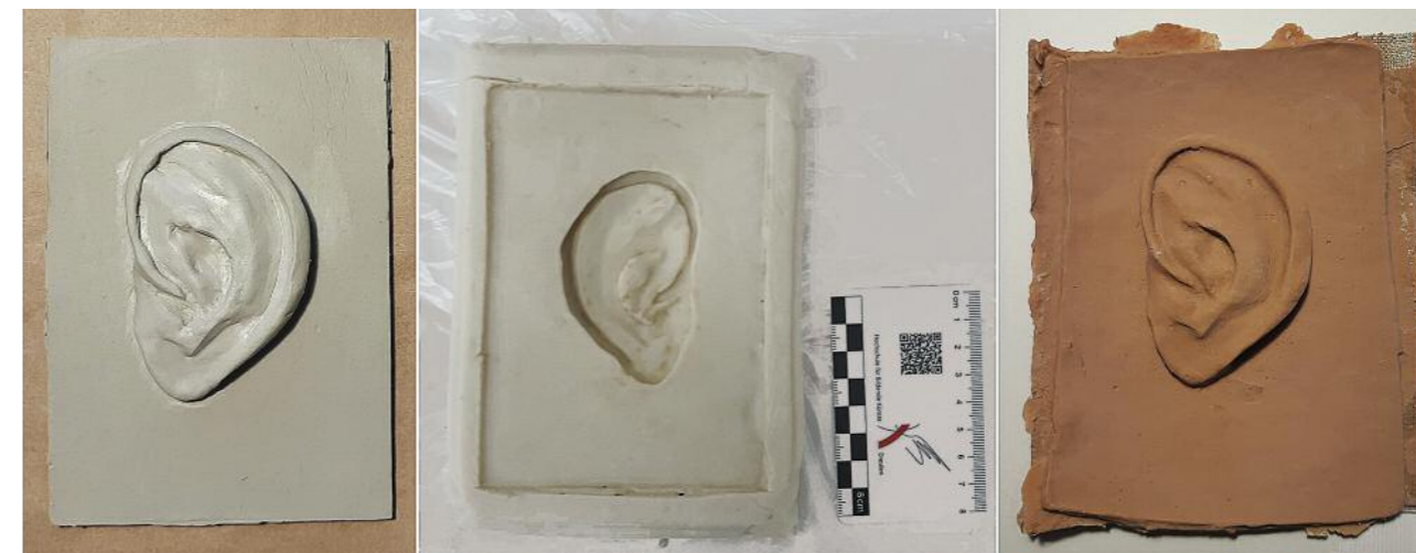
9 Links: aus Ton modelliertes Relief, Mitte: Negativ-Gussform, rechts: gegossene Form
