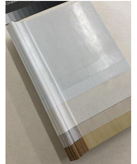
13 Erzeugung eines ebenmäßigen Glanzes durch die Politur der Weingeistfirnisse
