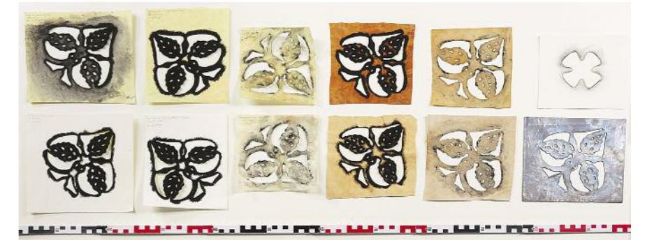
21 Schablonenmaterialien: Kartäuserkarton (nicht in den Vergleich eingeflossen), Büttenpapier, Pergament, Sämisch-Ziegenleder, Fensterleder, Blei (obere Schablonen geölt, unten ungeölt)
