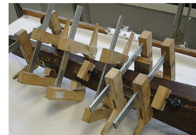
16 Nivellierung mit Wirbelwinden und partieller Druck über Klemmsia-Zwingen
