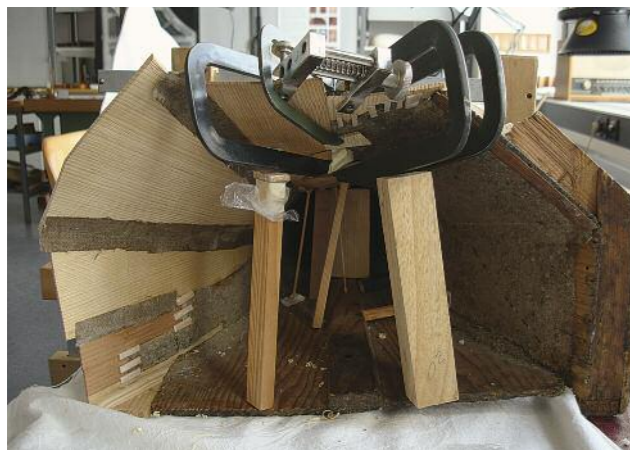
17, 18 Einleimen der ergänzten Späne
