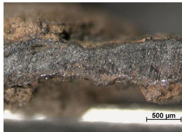
6 Querschliff eines Objektes mit Brandpatina. Innerhalb der Konglomerate ist keine definierte Schicht erkennbar.
