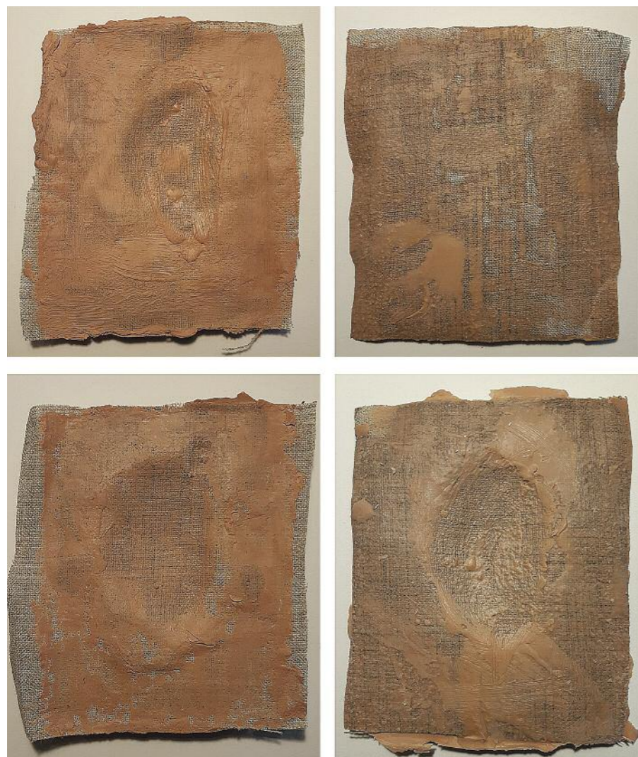
11 Rückseiten der gegossenen Reliefs aus den praktischen Versuchen. o. l.: Variante (3), o. r.: Variante (2), u. l.: Variante (1), u. r.: Kombination Variante (1) und (2)
