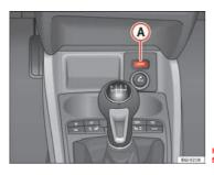
Fig. 101 The Start-Stop function button.
