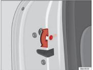
Fig. 44 Childproof lock on the left hand side door
