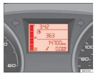
Fig. 37 Service interval display
