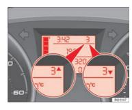
Fig. 33 Gear display
