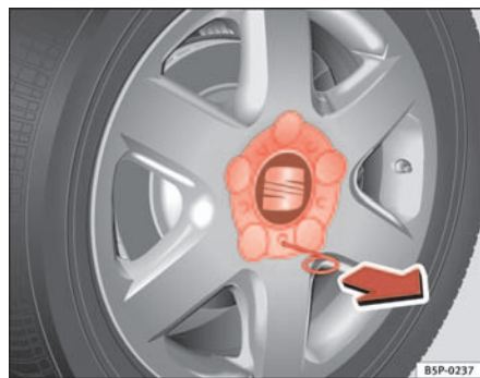
Fig. 129 Cambio de rueda: Retirar el embellecedor de la rueda
