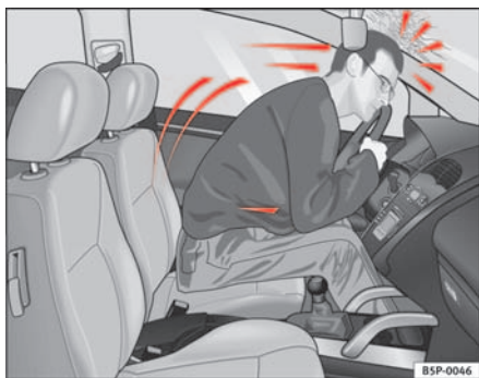
Fig. 8 El conductor que no lleve puesto el cinturón de seguridad se verá lanzado hacia adelante
