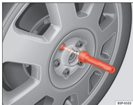
Fig. 134 Cambio de rueda: Útil de hexágono interior para girar los tornillos
