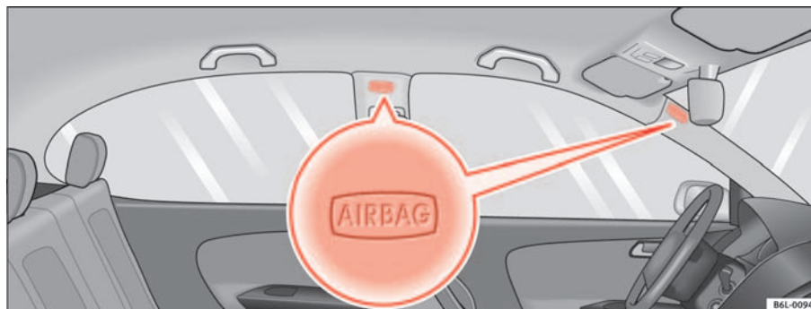
Fig. 23 Ubicación de los airbags para la cabeza en el lado izquierdo del vehículo
