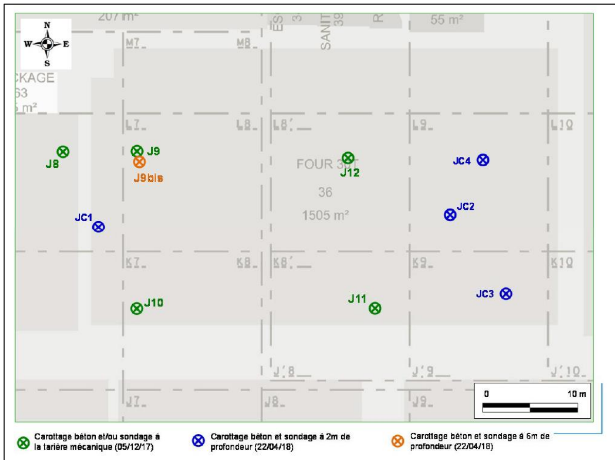
Figure 41 : Plan de localisation des investigations au droit du bâtiment J (source : rapport IDA180114_B, IDDEA Juin 2018)
