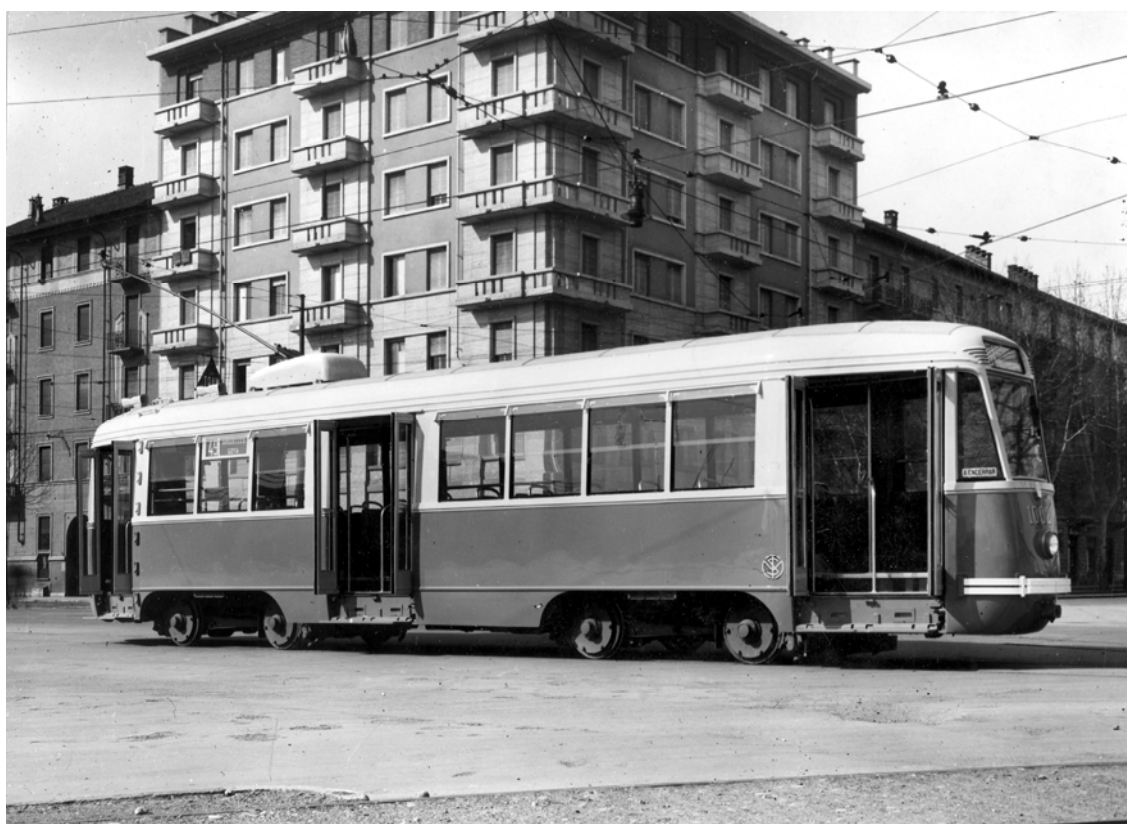
Imagen nº 49: Madrid adquirió a la italiana Fiat, a partir de 1943, tranvías del tipo PCC. En su momento, eran los más modernos de Europa y su tecnología y capacidad era muy superior a la de los autobuses o trolebuses contemporáneos. Archivo del Museo Vasco del Ferrocarril.
