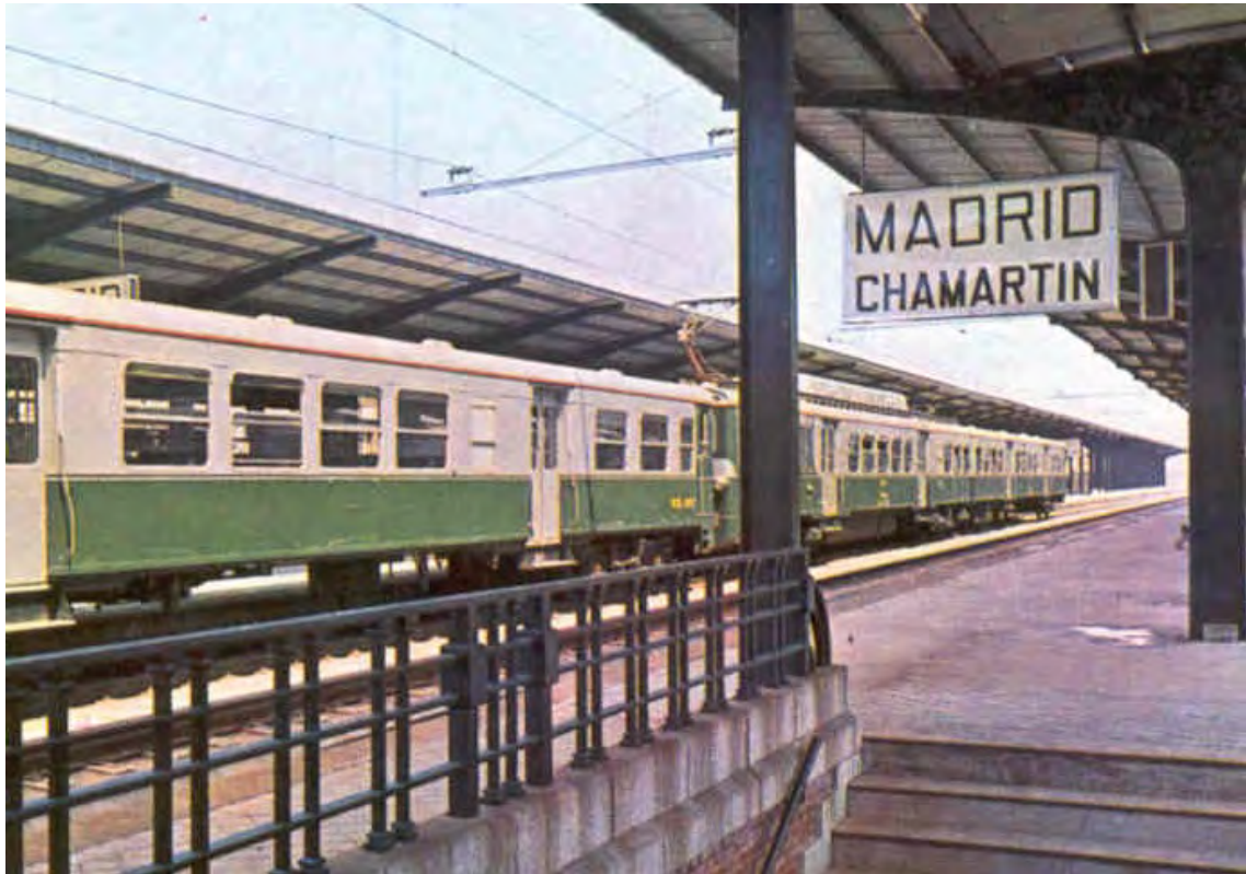
Figura 9. La progresiva mejora de la red electrificada hizo necesaria la incorporación de automotores eléctricos, como los de la serie 900, capaces de funcionar indistintamente en 1500 y 3000 v. La primera de ellas se incorporó en 1967.
