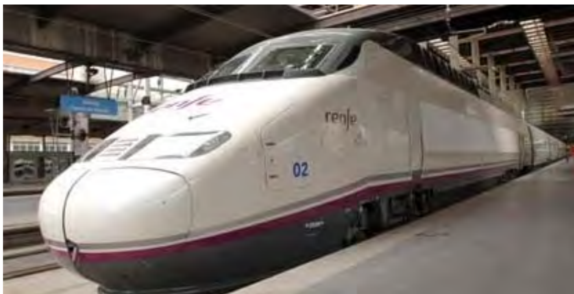
Figura 20. Tren serie 100, los primeros en prestar servicio en la línea de AVE Madrid-Sevilla. Evolución del TGV Atlántico, incorporó nuevos elementos como los equipos de control y señalización LZB y Asfa.
