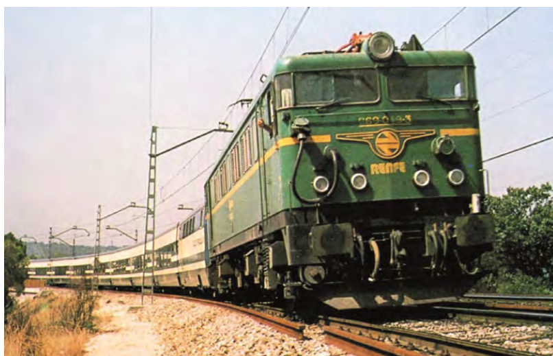
Figura 16. Con el avance de las líneas electrificadas llegaron nuevas unidades de tracción como las locomotoras de la serie 269, fabricadas entre 1973 y 1985, que remolcaron tanto trenes de viajeros como de mercancías.
