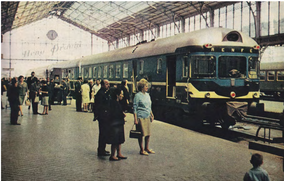
Figura 14. Los automotores TER fueron construidos en 1965 bajo licencia FLAT por CAF-MMC. Sus composiciones se formaban por dos coches motores extremos y dos remolques centrales, aunque su composición más habitual fue en semitrén (M+Rc). Los TER prestaron servicios comerciales por toda la red entre 1965 y 1995.
