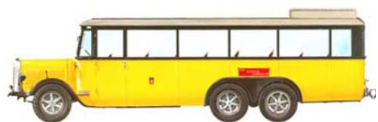
Allwetterwagen Saurer 3 BPS BLD, 1932 in einer Serie von 8 Wagen beschafft; aber 1941/42 bei Saurer im Auftrag der Post wieder auf 2-Achsen zurückgebaut (siehe Seite 02)
