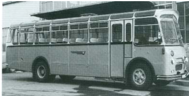
Unterflur-Alpenwagen IV-U Saurer 3DUX 1964 mit nachgerüsteter automatischer Türe
