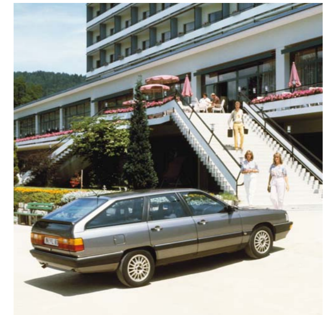
Die dritte Audi-100-Generation (C3, 1982–1991) gab es wieder als Avant. Nach 1985 wurde die Karosserie vollverzinkt.
