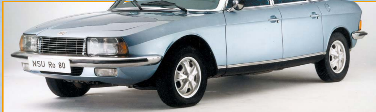
Bis heute unvergessen: Der NSU Ro 80, die einzige deutsche Wankellimousine. Sie blieb zehn Jahre in Produktion und wurde 37.400 Mal gebaut. 115 PS stark, gehörte die Dreigang-Halbautomatik zum Serienumfang. (Foto: © Audi AG)
