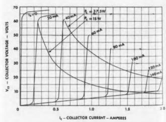
BASE VOLTAGE VS. COLLECTOR CURRENT - COMMON EMITTER
