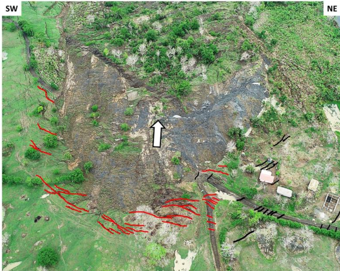
Figura 46. Familias de grietas identificadas en la zona de inicio Las líneas rojas marcan la tendencia de la familia 1 y las líneas negras las de la familia 2. La flecha blanca indica la dirección principal de desplazamiento del material movilizado.
