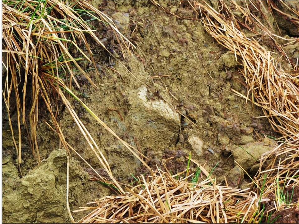
Figura 22. Proportión de clastos dentro del almacén del suelo Visual hacia la masa desplazada en la parte alta del movimiento.
